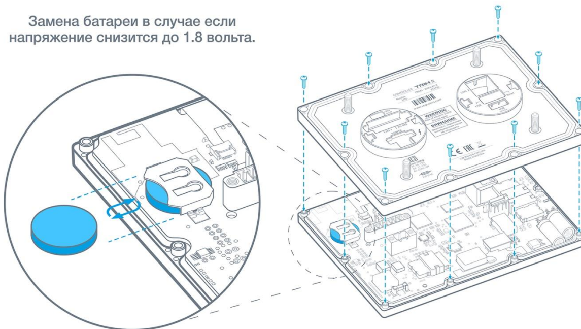
Рис. 15 - Порядок замены литиевой батареи
