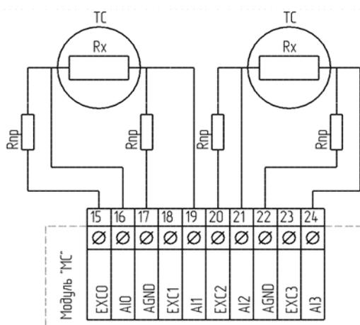
Рисунок 24. Схема четырехпроводного подключения резистивных датчиков
