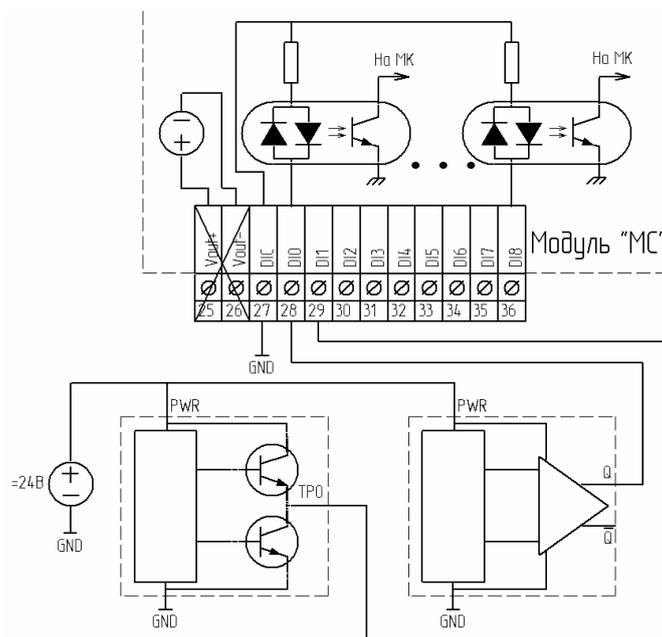
Рисунок 16. Пример подключения датчиков с активным выходом.
