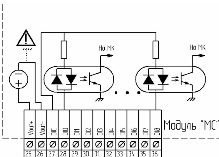
Рисунок 11. Упрощенная электрическая принципиальная схема цифровых входов МС. DIC – общая клемма, Dix – вход двунаправленного оптрона, Vout+ Vout- - выходы внутреннего источника напряжения цифровых входов.
