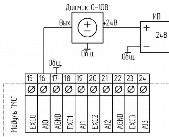
Рисунок 20. Пример подключения датчика с выходом «0-10В»
