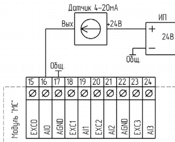
Рисунок 21. Пример подключения датчика с выходом «4-20мА»
