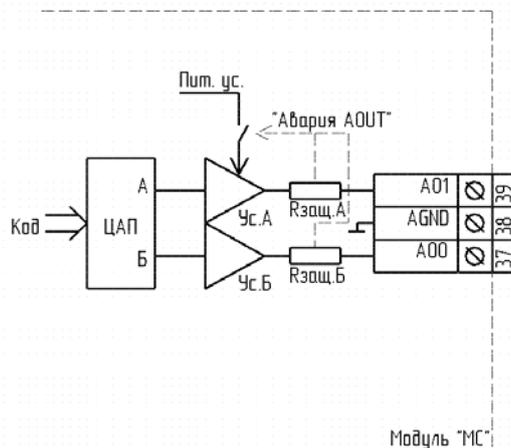
Рисунок 27 Структурная схема аналоговых выходов МС; Рзощ – датчик вытекающего тока. Вырабатывает управляющий сигнал «Авария А0UТ», Пит.ус. – питание выходного каскада, Ус. – усилители.
