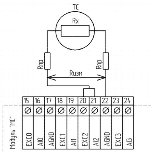
Рисунок 22. Схема двухпроводного подключения резистивных датчиков
